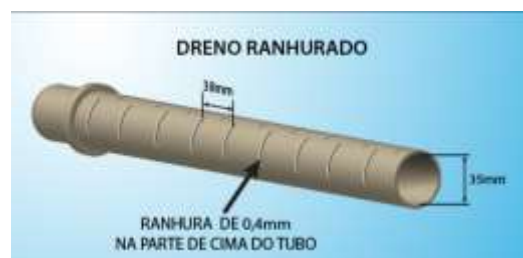
Figura 10: Detalhe dos DHP's utilizados na obra
