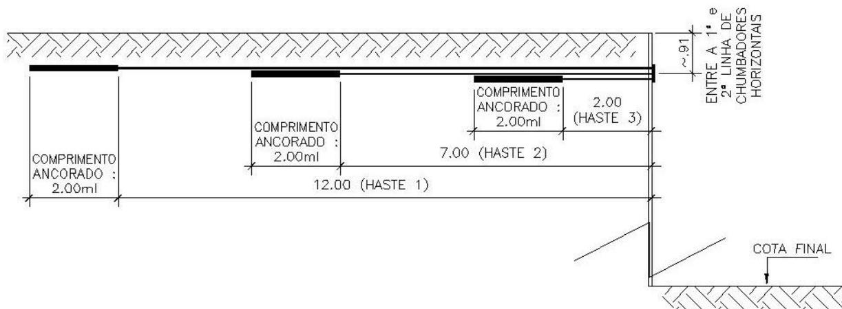
**Figura 10:** Exemplo de montagem do extensômetro instalado na obra
