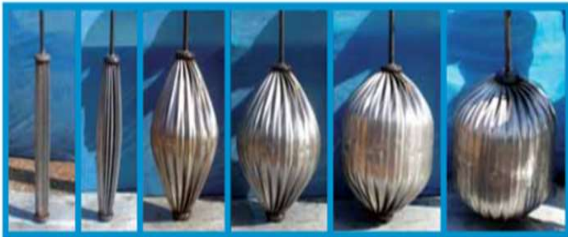
Figura 1: processo controlado de expansão do Expander Body, Silva et al. (2018).
