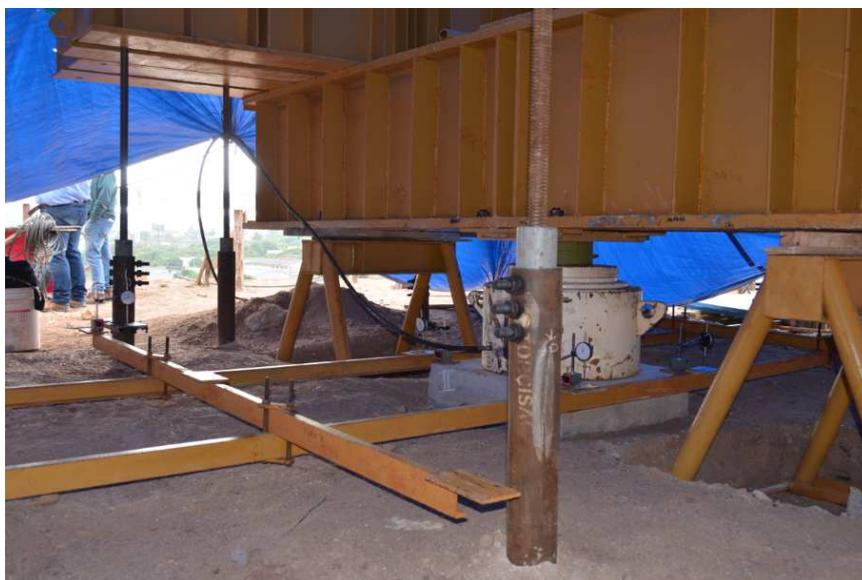
Figura 3. Estacas e Vigas de Reação
