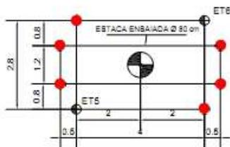
● ESTACAS DE REAÇÃO    ● ESTACAS DE REAÇÃO MONITORADAS
