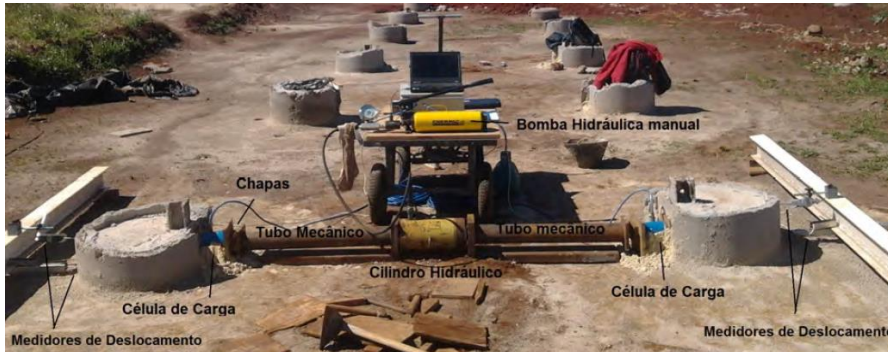
Figura 3. Sistema de carregamento lateral das estacas nos ensaios. (FARO, 2014)
